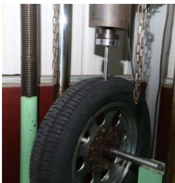
輪胎破壞能測試(圖二)
