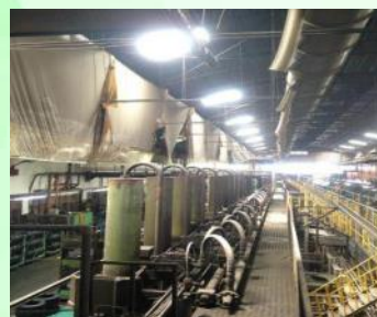
加硫機油壓缸上方增設手動天車
